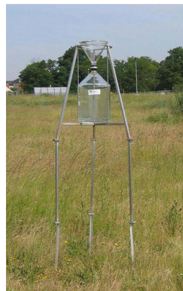
Photo 1 : Préleveur passif type Jauge Owen sur trépied.
