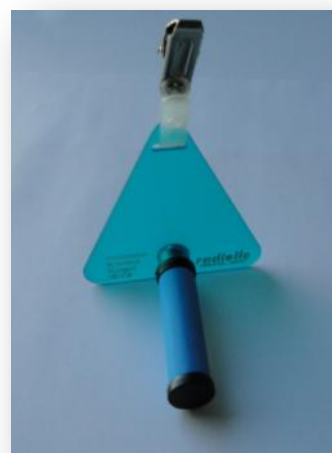
Photo 3 : Dispositif d'échantillonnage passif pour le formaldéhyde
