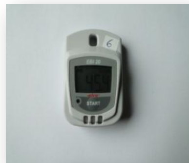
Photo 5 : Sonde d'enregistrement de température et d'humidité
