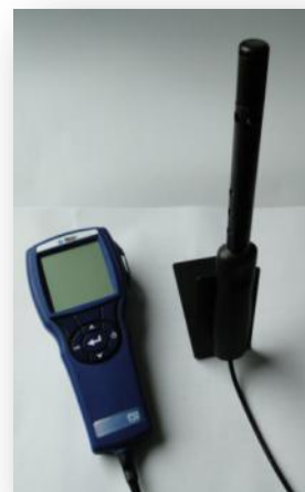
Photo 6 : Appareil de mesure du confinement (CO 2 )
