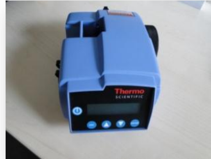
Photo 4 : Néphélomètre portatif pour la mesure des PM_{2,5}
