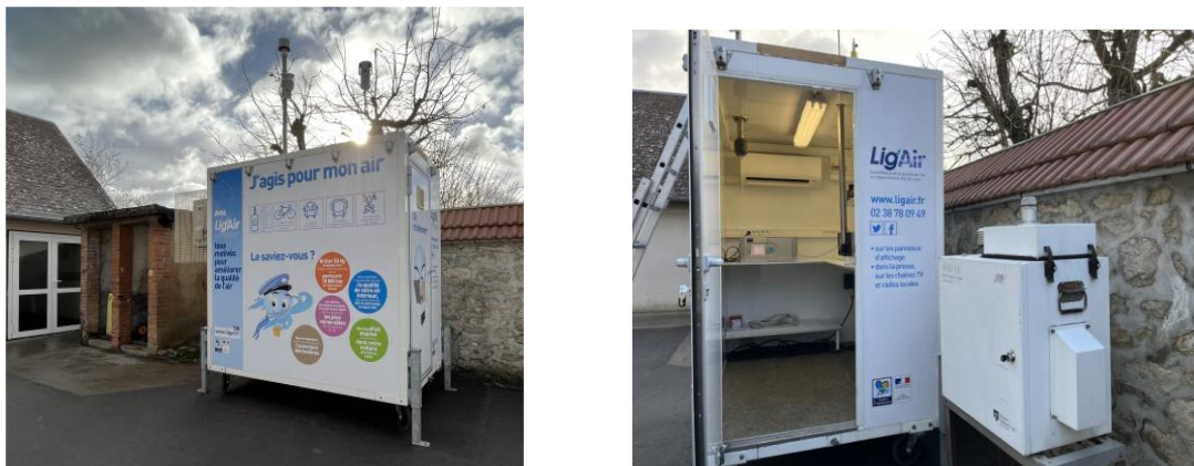
Figure 7 : photos de la station mobile dans la cour de l'école d'Engenville ainsi que du préleveur métaux
