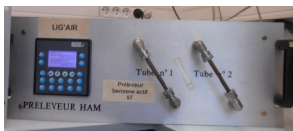
Figure 4 : préleveur actif des BTEX
